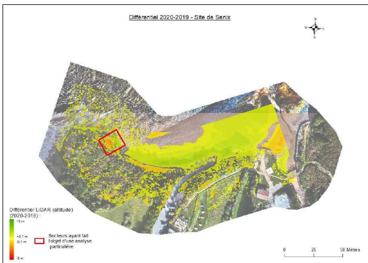
Illustration 28 - Différentiel lidar 2020-2019, dans le secteur de Sénix (@Observatoire de la Côte Aquitaine, Hélimap)
