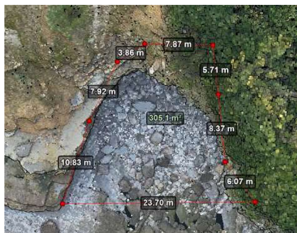
Illustration 18 - Cavité a de la Pile d'Assiettes : dimensions en haut, vue de perspective à gauche, vue azimutale à droite
