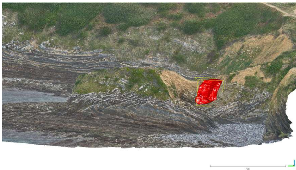
Illustration 58 - Vue 3D de la zone d'évolution, en partie ouest du secteur d'Archilua. Orthophotos et analyse différentielle des données lidar des campagnes 2019 et 2020 (en rouge : zone érodée ; ©Observatoire de la Côte Aquitaine, HéliMAP)
