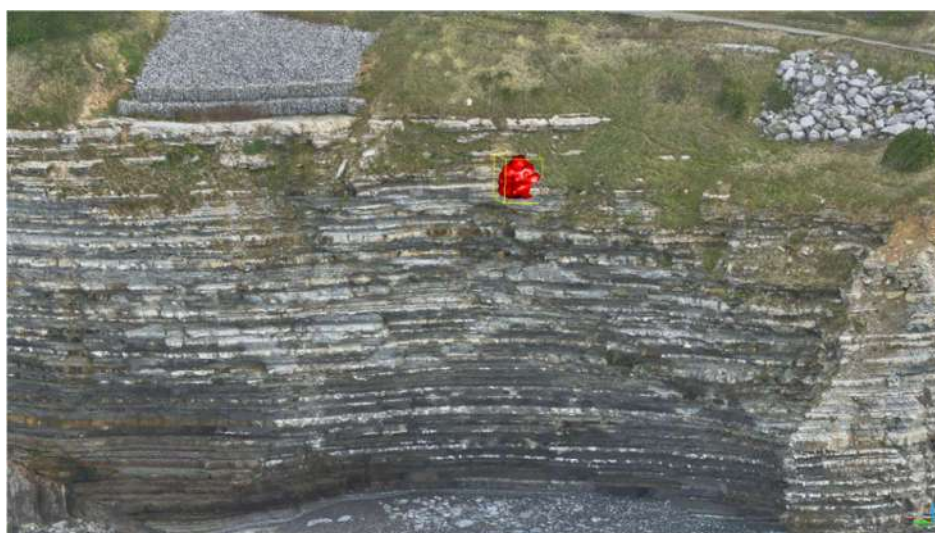
Illustration 64 - Identification sous Cloudcompare© de la rupture d'un compartiment rocheux de 5 m 3 , en partie centrale du secteur de Sainte-Barbe, entre 2019 et 2020 (vue 2020, en rouge : zone érodée ; ©Observatoire de la Côte Aquitaine, Hélimap)
