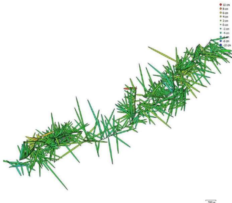
Figure 7 : Résidus sur le positionnement GPS-inertiel (trajectoire) de chaque image
