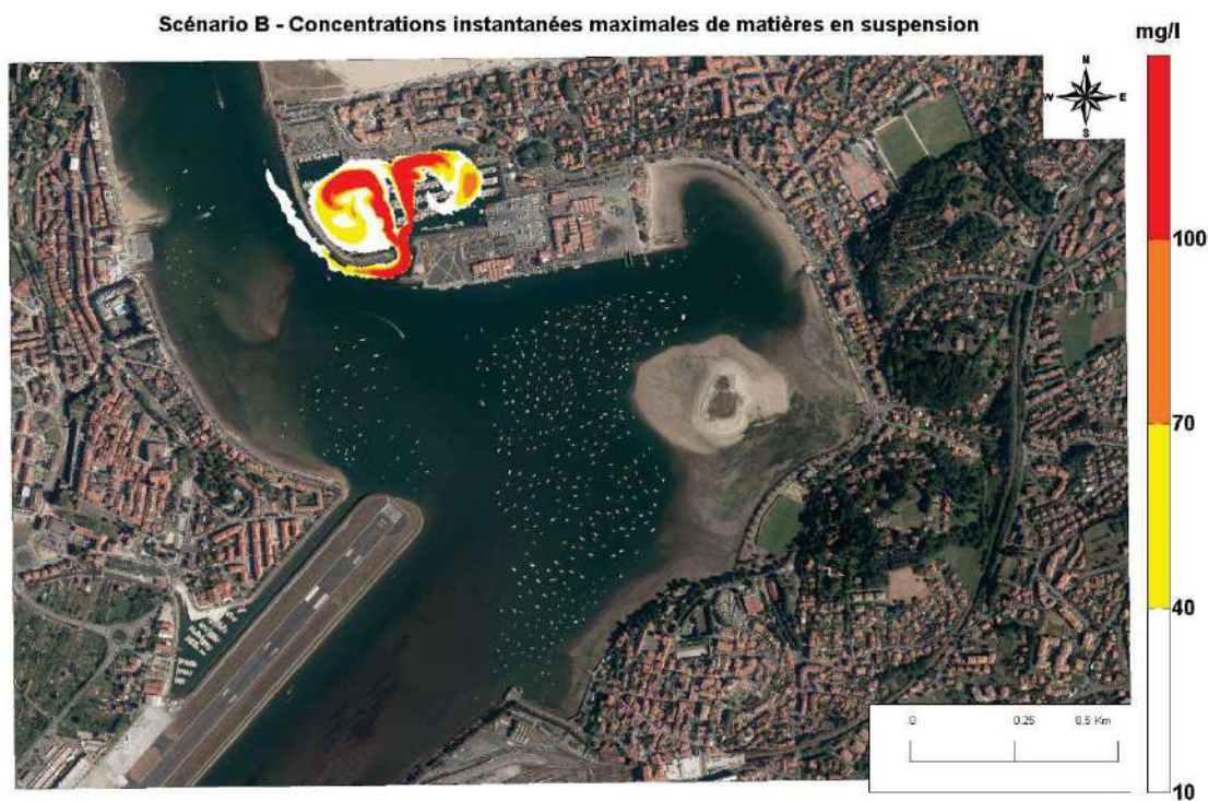
Figure 29: Emprise des concentrations instantanées maximales de matières en suspension en 15 jours de dragage du port de plaisance (scénario B).
