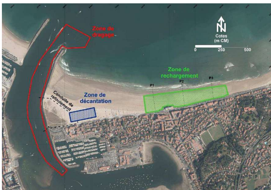
Figure 44: Localisation des zones de dragage, de rechargement, de décantation des sables et de la conduite de refolement.
