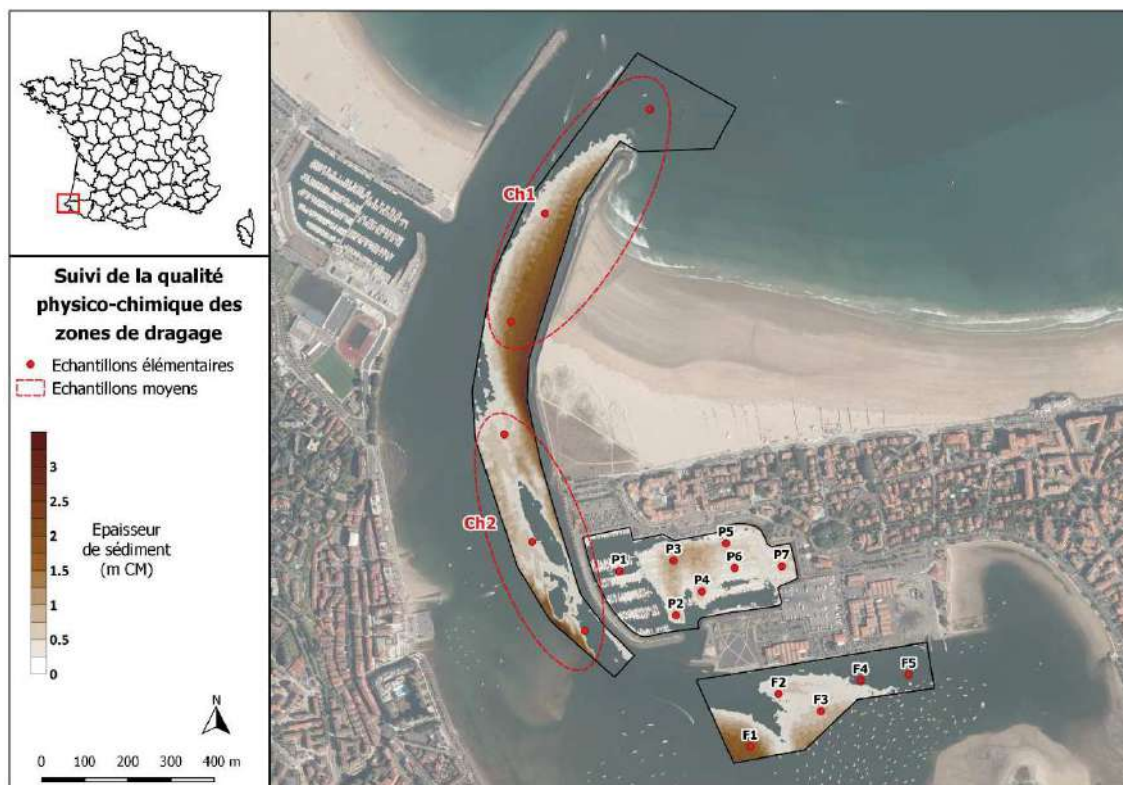
Figure 45: Proposition de plan d'échantillonnage pour le suivi de la qualité physico-chimique des futurs déblais.
