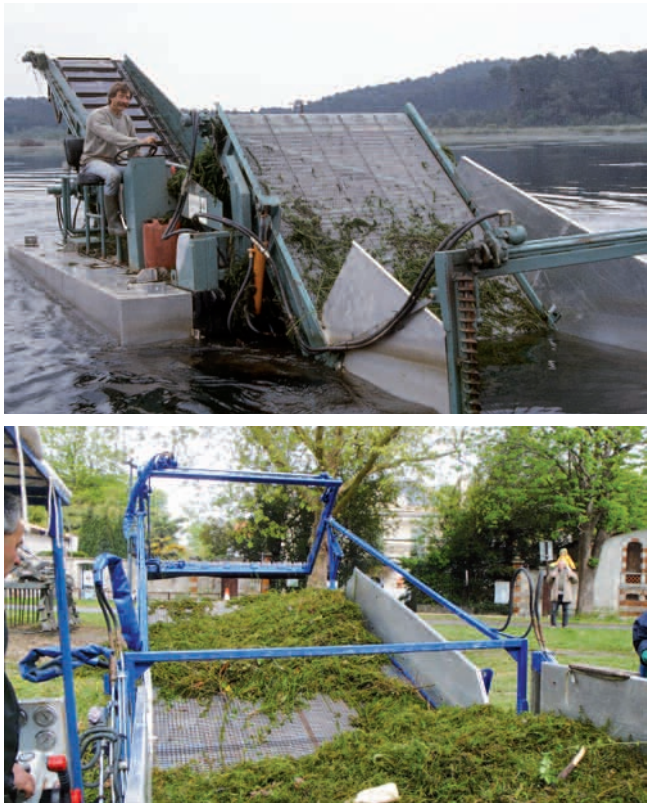
Bateau moissonneur (barres de coupe et tapis roulant d'extraction).
