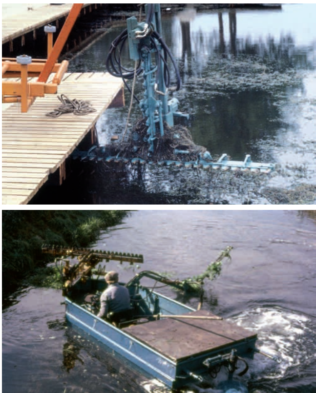
Bateaux faucardeurs équipés de barres de coupe à l'avant et latéralement.
