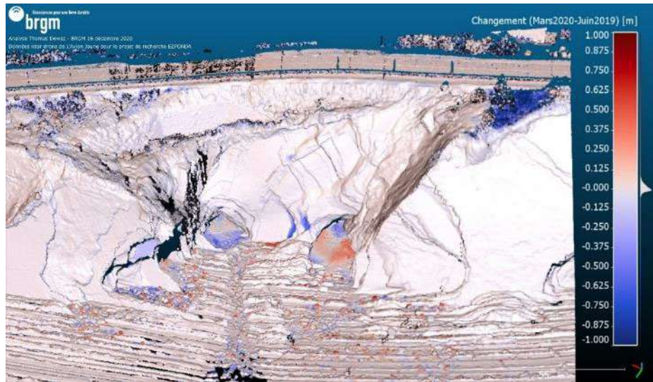
Illustration 7 - Différences entre les mesures lidar du 10 mars 2020 et du 20 juin 2019, pour le tronçon 5 ; les valeurs négatives (bleues) figurent le départ de blocs (données l'Avion Jaune pour le projet EZPONDA)
