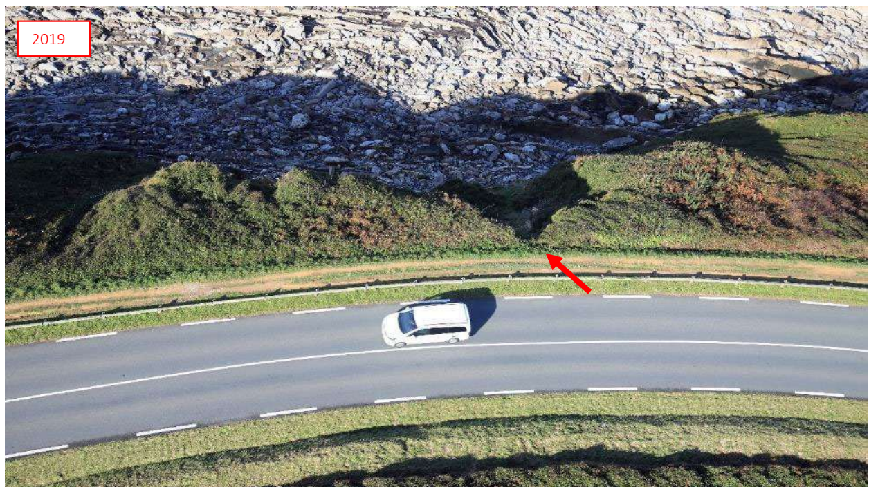
Illustration 34 - Vue générale du tronçon 17 et positionnement de l'encoche érosive de la zone 1, remontant jusqu'en sommet de falaise (©Observatoire de la Côte Aquitaine, Balloide Photos, 2019)
