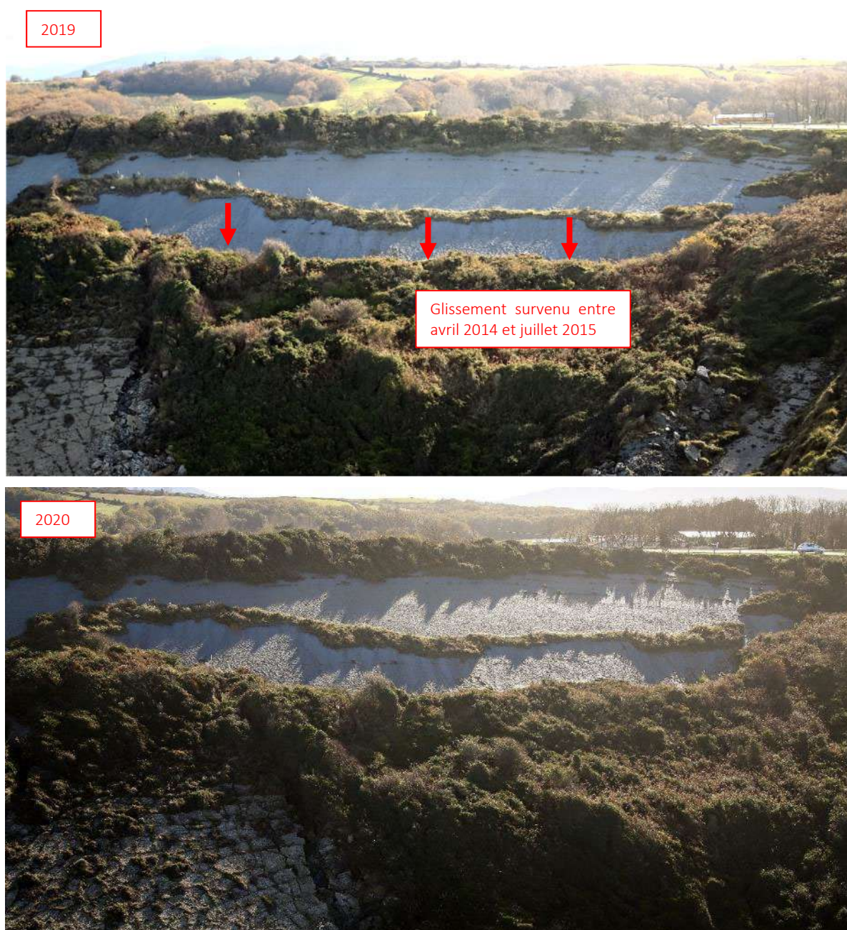
Illustration 33 - Vue de détail du tronçon 15 : absence d'évolution significative constatée dans la partie supérieure de la zone 4, entre les campagnes du 26/11/2019 et du 17/11/2020 (@Observatoire de la Côte Aquitaine, Balloide Photos, 2019 et 2020)
