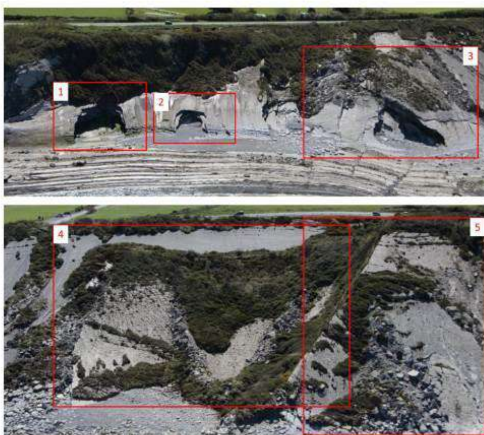
Illustration 23 - Vue d'ensemble du tronçon 15 avec identification des zones de détails ; zones 1 à 3 : cavités formées par ablation en pied de paroi, zones 4 et 5 : activité « glissement de terrain » active ou suspectée (©Observatoire de la Côte Aquitaine, Balloide Photos, 2014)
