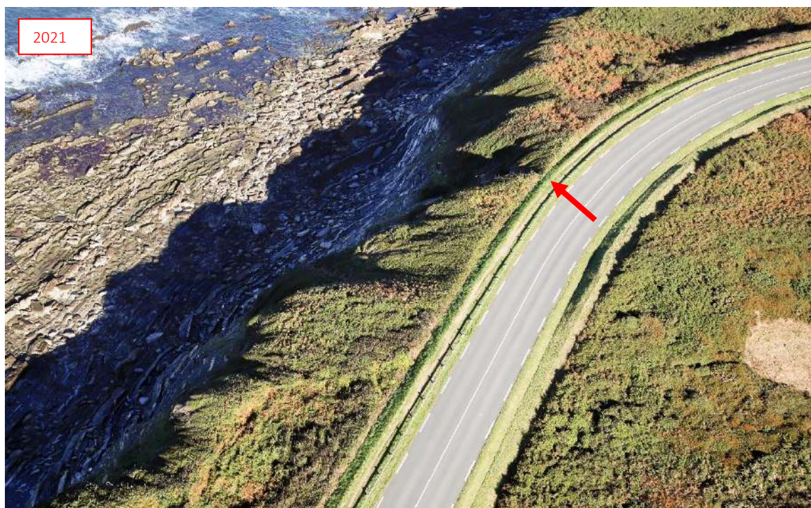
Illustration 29 - Vue générale du tronçon 17 et positionnement de l'encoche érosive de la zone 1, remontant jusqu'en sommet de falaise (©Observatoire de la Côte Aquitaine, Balloide Photos, 2021)
