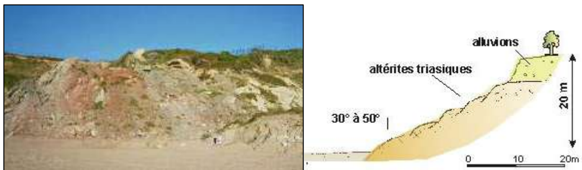
Figure 33 : Coupe schématique de la falaise située sous la Villa des Ailes sur la plage de Pavillon Royal (Aubié, 2008).
