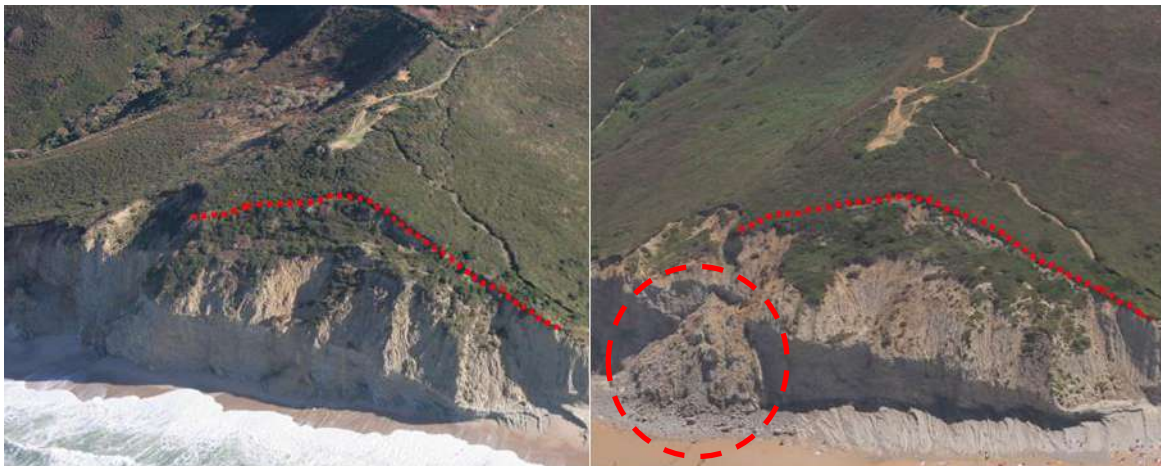
Figure 35 : Mouvement de versant d'Erretegia nord - évolution de la niche d'arrachement sommitale entre 2008 et 2013 et cône d'éboulis de novembre 2012 (© Observatoire de la Côte Aquitaine, Michel Le Collen).
