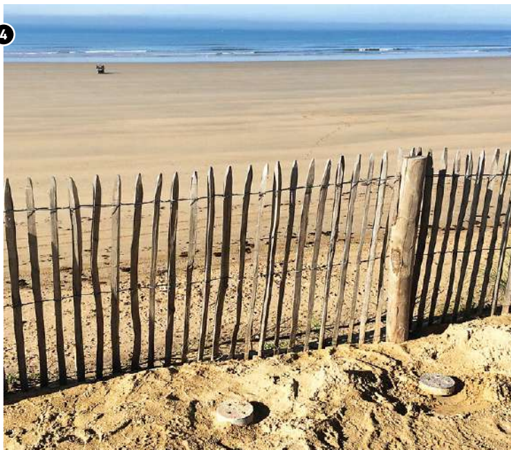
▲ PHOTO 4 / Acquisition sismique sur l'estran avec piezomètres au 1 er plan. © VIVIEN BAUDOUIN
