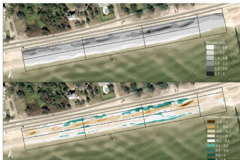
Illustration 14 - Raster des altitudes au début de l'étude (haut) ; différences d'altitudes calculées entre les levés LIDAR du début de l'étude et de fin d'étude (bas) (Provost et al., 2022)
