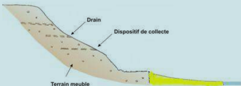
Schéma montrant le procédé du système de drainage par drains subhorizontaux (BRGM)
