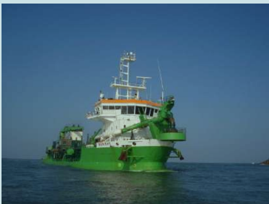
Exemple d'application de la technique de rechargement par clapages côtiers, Anglet (64), (Casagec, 2010)
