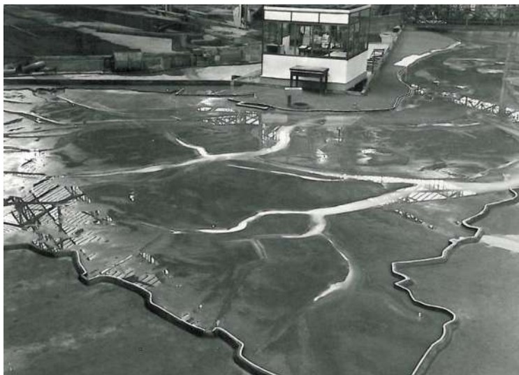
Modèle physique du bassin d'Arcachon vue depuis le nord-ouest. Cabine de contrôle sur Arcachon et la Teste-de-Buch en arrière de la dune du Pyla (d'après LCHF, 1973)
