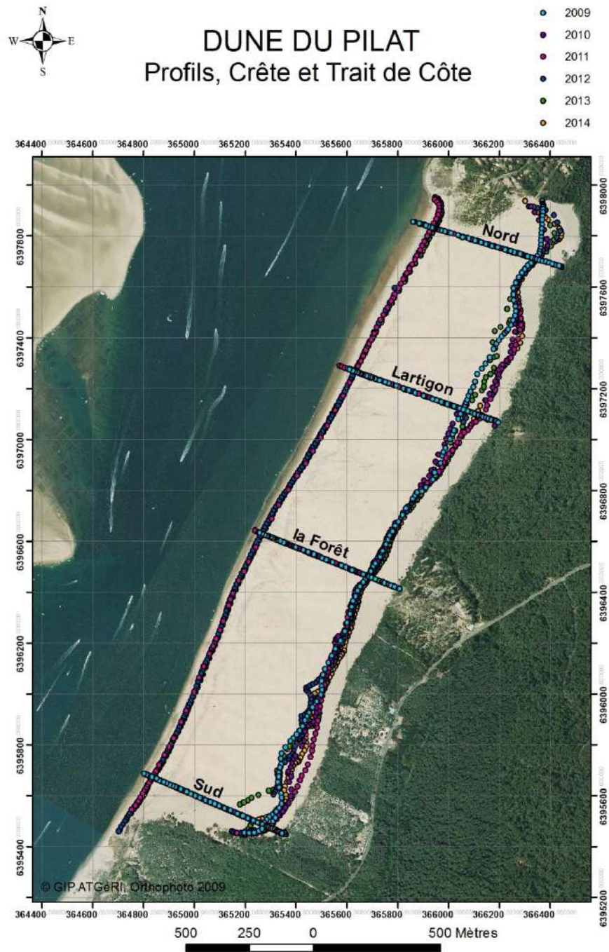
Figure 78 : Comparaison diachronique des levés longitudinaux du trait de côte et de la crête sur la dune du Pilat. Les 4 profils suivis annuellement sont également représentés.
