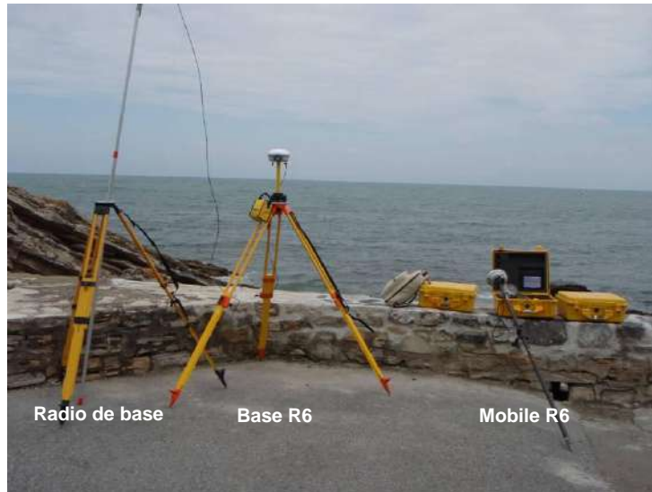
Figure 13 : Présentation du système DGPS Trimble® R6
