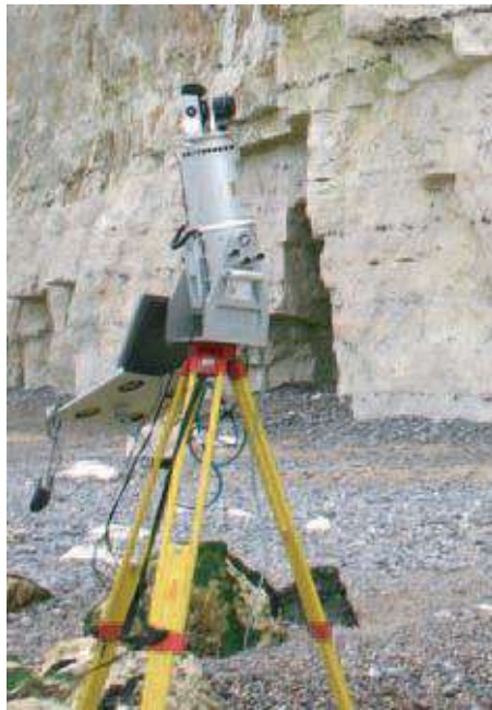
Figure 37 : Scanner 3D ou LiDAR terrestre (Riegl LMS-Z 420i ; © ATM 3D)
