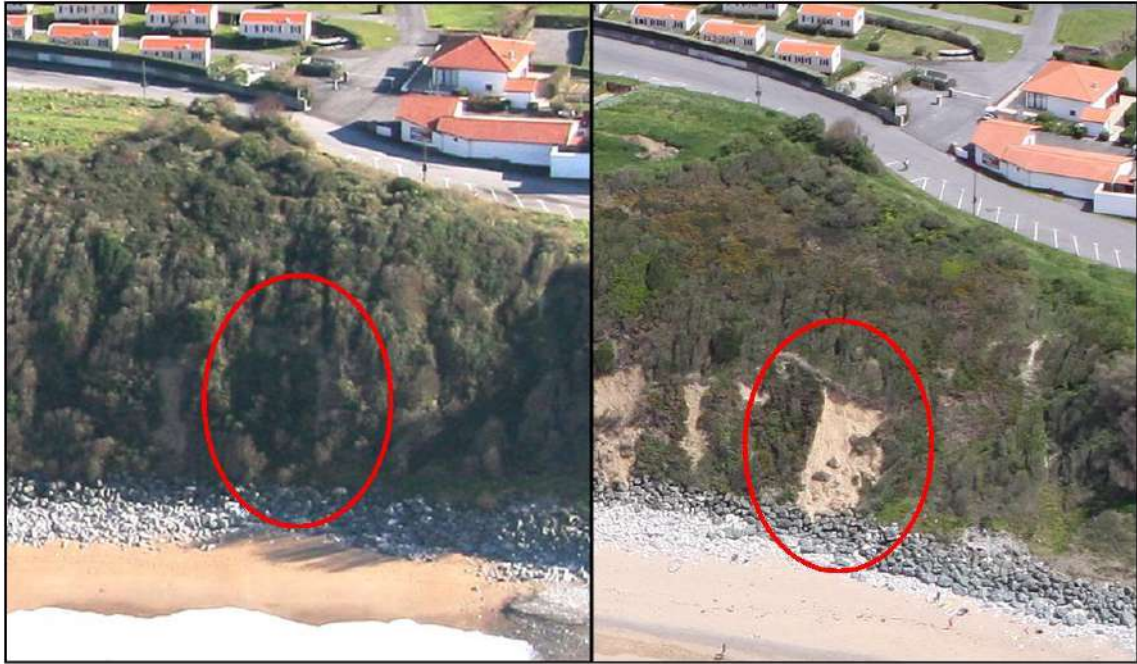
Figure 44 : Etude diachronique de photographies aériennes obliques datant de 2008 (à gauche) et 2010 (à droite), révélant un mouvement de terrain, au niveau de la plage de Maiarko à Saint-Jean-de-Luz (© Observatoire de la Côte Aquitaine)
