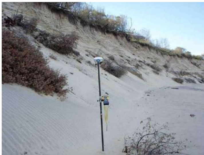
Figure 30 : Système du DGPS (mobile Trimble R6®) positionné au pied de dune, Aquitaine, Amélie Sud, 2011 (© Observatoire Côte Aquitaine)
