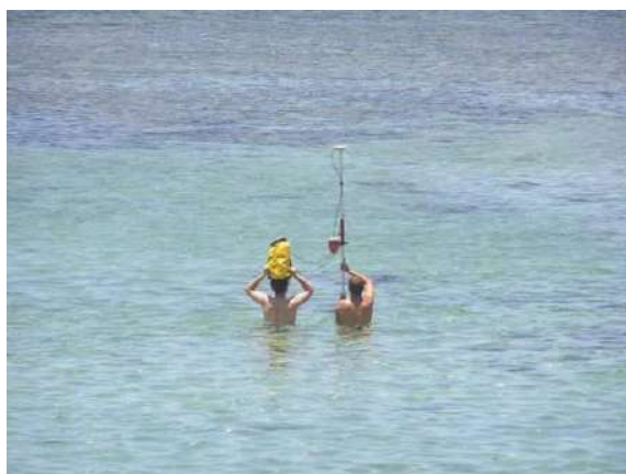
Figure 33 : Exemple de levé topographique immergé dans une DAR peu profonde (De la Torre, 2006)
