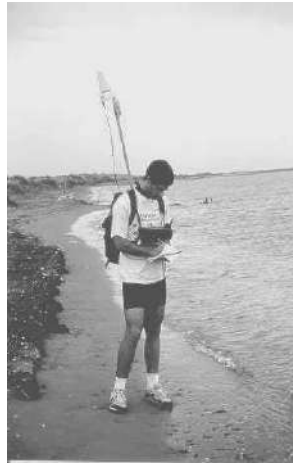
Figure 10 : Relevé de la position du trait de côte, limite du jet-de-rive (© Sabatier, 2001)
