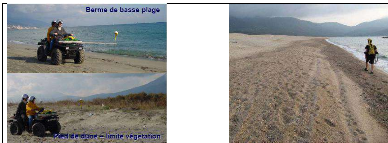
Figure 32 : Méthodes de relevé de la position du trait de côte (Stepanian et al., 2011) : les levés longitudinaux du trait de côte sont effectués à l'aide d'un DGPS installé sur un quad ou transporté par un opérateur.
