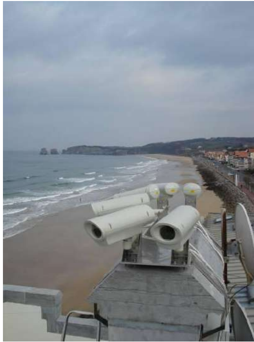
Figure 41 : Système de suivi vidéo (VM 4 GIS / CASAGEC ; Rihouey, 2011)
