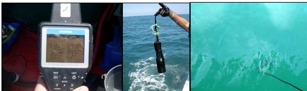
Figure 9 : Illustration de la sonde Horiba U53G utilisée pour les profils verticaux de physico-chimie de l'eau (Source : IMA)
