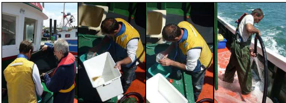
Figure 8 : Illustration de la préparation des échantillons et du rinçage des nappes (Source : IMA)
