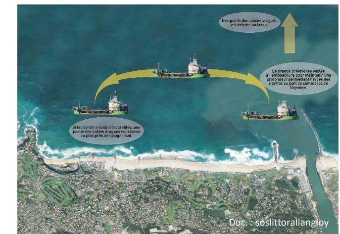
Cependant un dragage et un clapage (déversement des sables et boues en mer) restent nécessaires : le schéma ci-dessus montre son principe.
