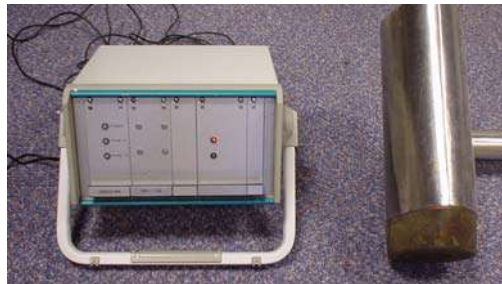
Photo 8 : Présentation du rack permettant l'interface du matériel de positionnement. À droite le transducteur 120 kHz.
