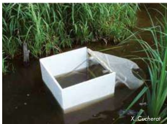
Adaptation d'un dispositif de type Surber au milieu lentique* (CUCHERAT, 2003)
