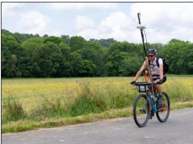
Le géophysicien-cycliste est chargé d'y mesurer le champ magnétique. Il est impossible de le faire en voiture à cause du métal de la carcasse qui parasiterait les mesures. Le vélo a un cadre carbone pour ne pas perturber les
