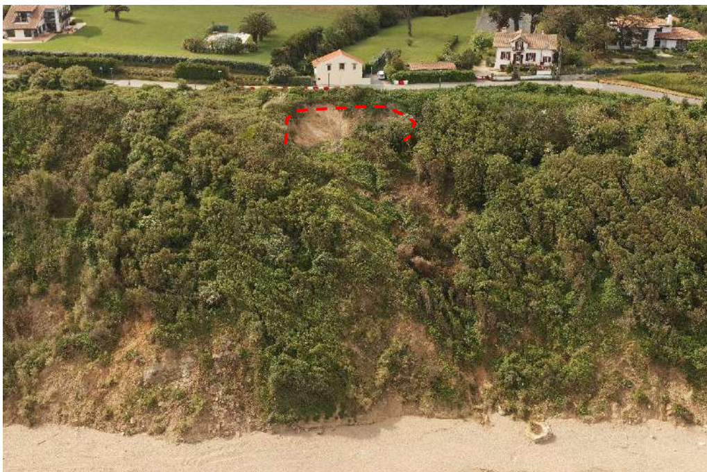
Illustration 33 - Secteur de Lafitenia : vue aérienne oblique, datée du 12 mai 2022, du glissement de terrain survenu le 11 décembre 2021 et identification indicative de la niche de décrochement sommitale (©Observatoire de la côte de Nouvelle-Aquitaine, Instadrone)
