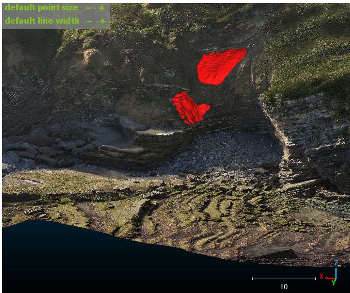
Illustration 59 - Site 2 du secteur de la Pile d'Assiettes : vue 3D des masses éboulés (en rouge) superposées au nuages de points 2023
