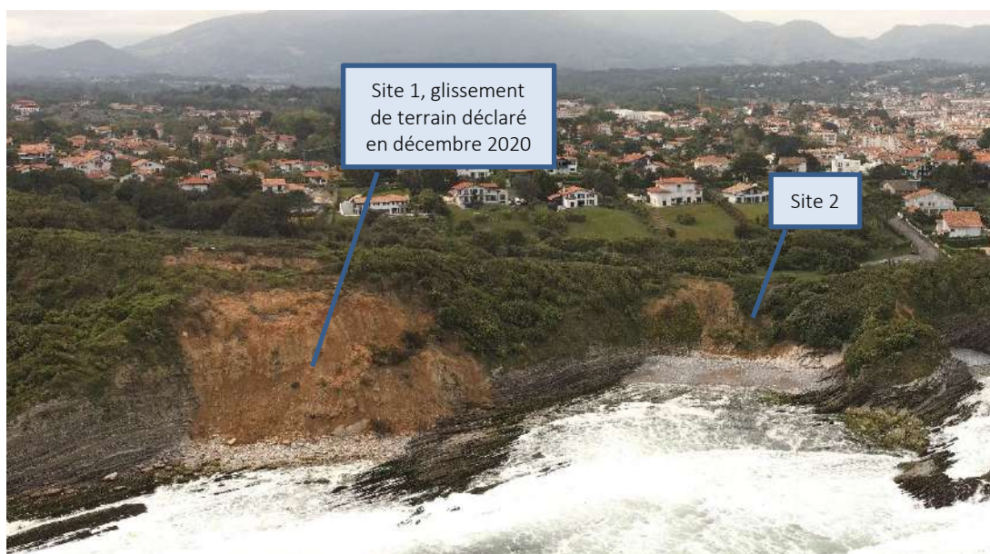
Illustration 47 - Sites 1 et 2 du secteur d'Archilua : vue aérienne oblique, datée de mai 2022, des zones de glissement identifiées par analyse différentielle 2022-2021 des données lidar (©Observatoire de la côte de Nouvelle-Aquitaine, Instadrone)
