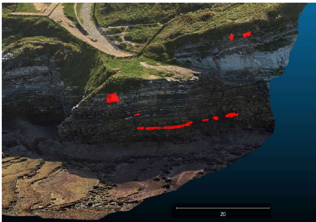
Illustration 62 - Zoom sur la partie sud de la vue 3D de la falaise de Sainte-Barbe (©Observatoire de la côte de Nouvelle-Aquitaine, Helimap) ; localisation des compartiments rocheux tombés entre 2022 et 2023 (en rouge)
