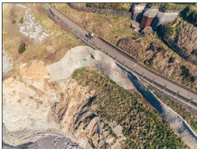
Illustration 10 - Glissement de terrain (couverture meubles - colluvions et altérites - recouvrant les flyschs) au droit de la Promenade Feodor Chaliapine, le 03/12/2002, bordant l'ancienne route (cliché de gauche), et vue aérienne du confortement actuel de cette partie de falaise (cliché de droite ; ©Observatoire de la Côte Aquitaine, Com' by AVM, 2018)
