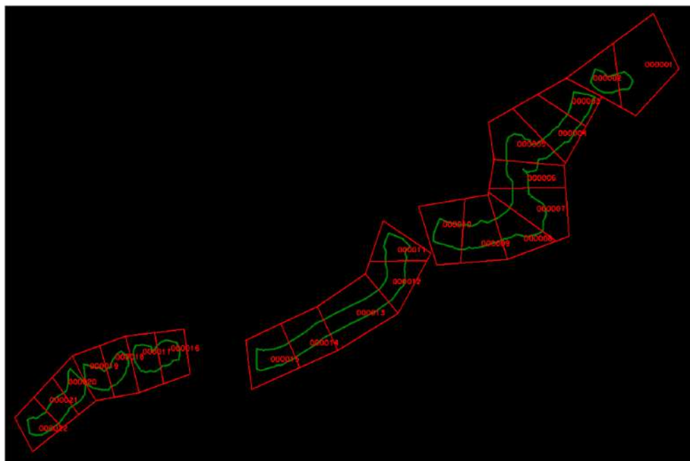
Figure 5 : Canevas de tuilage du nuage de points (source : MicroStation)
