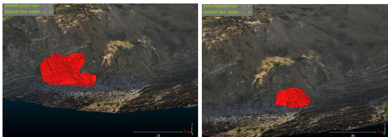
Illustration 50 - Site 1 du secteur d'Archilua : vues en 3D des décrochements en pied de falaise (en rouge) superposés sur le mesh 2023, réalisées à partir des différentiels de nuages de points des campagnes 2022 et 2023 (©Observatoire de la côte de Nouvelle-Aquitaine, Hélimap)
