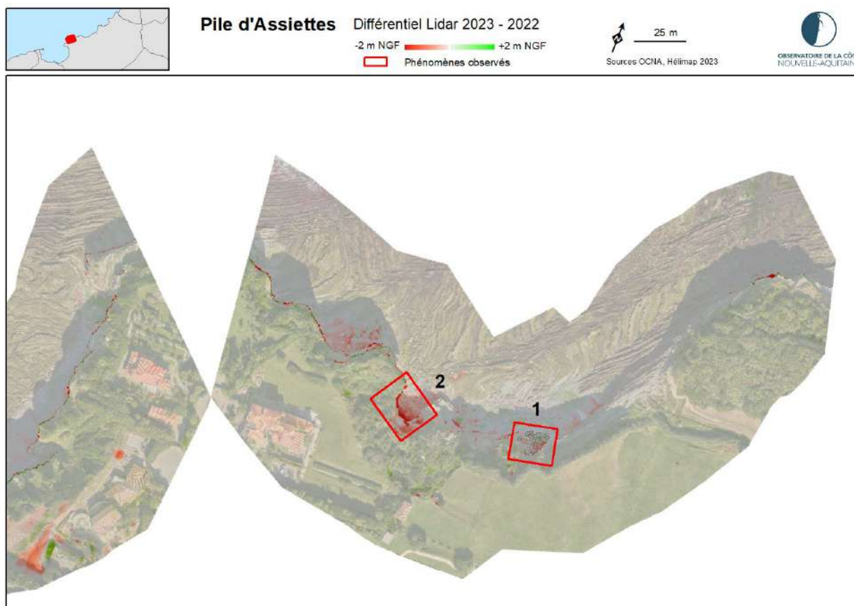
Illustration 54 - Différentiel lidar 2023-2022, dans le secteur de la Pile d'Assiettes (©Observatoire de la côte de Nouvelle-Aquitaine, Helimap)
