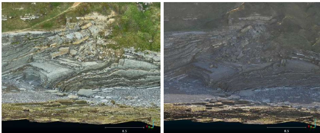
Illustration 56 - Site 1 du secteur de la Pile d'Assiettes : vues en 3D des volumes mobilisés à partir des différentiels de nuages de points des campagnes 2022 (à gauche) et 2023 (à droite) (©Observatoire de la côte de Nouvelle-Aquitaine, HéliMAP)
