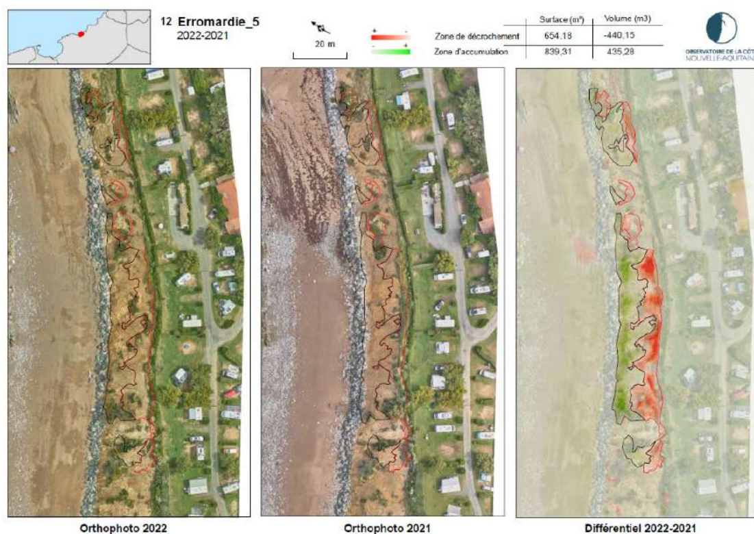
Illustration 38 - Orthophotos et analyse différentielle des données lidar des campagnes 2021 et 2022 (extrait du rapport BRGM/RP-72363-FR) (©Observatoire de la côte de Nouvelle-Aquitaine, HéliMAP)
