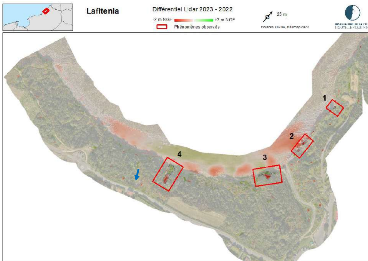
Illustration 22 - Différentiel lidar 2023-2022, dans le secteur de Lafitenia (©Observatoire de la côte de Nouvelle-Aquitaine, HéliMap) (flèche bleue : localisation du glissement de terrain de décembre 2021)
