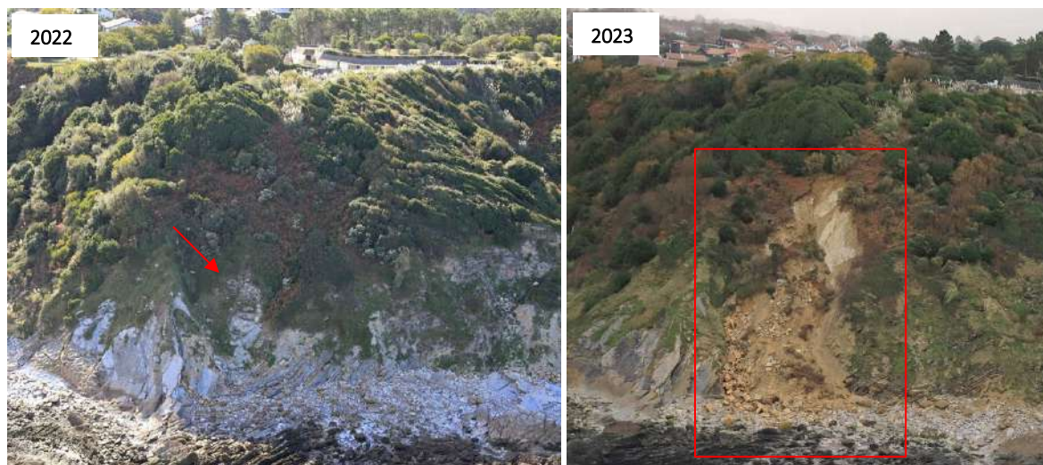
Illustration 37 - Glissement superficiel observé dans le secteur d'Archilua (site 22 ; ©OCNA, Balloïde, 2022 et 2023)
