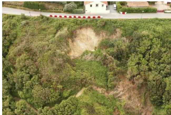
Illustration 34 - Vue aérienne de la partie supérieure du glissement de Lafitenia de décembre 2021 et des désordres occasionnés au sentier littoral (site 20 ; ©OCNA, Instadrone, 12/05/2022)
