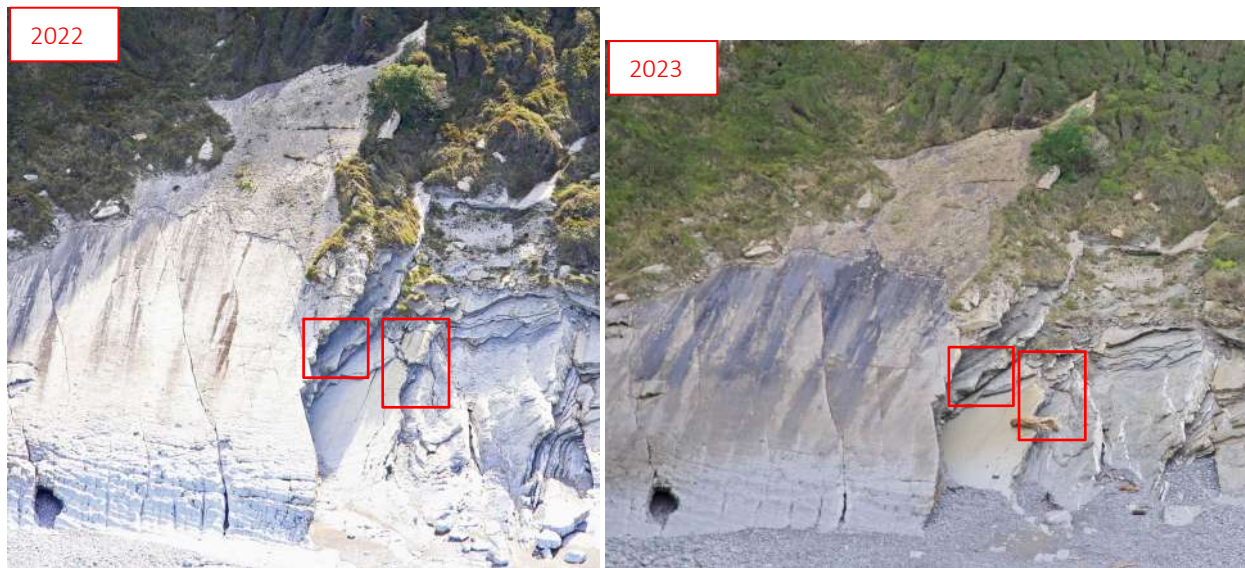
Illustration 21 - Vues de détail du tronçon 15 sur la zone 2 ; les encadrés rouges indiquent les emprises des départs de blocs constatés entre les campagnes du 26/10/2022 et du 12/12/2023 (@Observatoire de la côte de Nouvelle-Aquitaine, Balloïde Photos 2022 et 2023)
