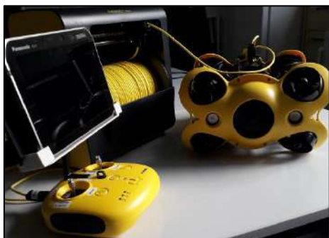
Figure 10. Drone sous-marin Chasing M2 ® avec ses accessoires et sa mise en œuvre dans l'eau © Ifremer.
