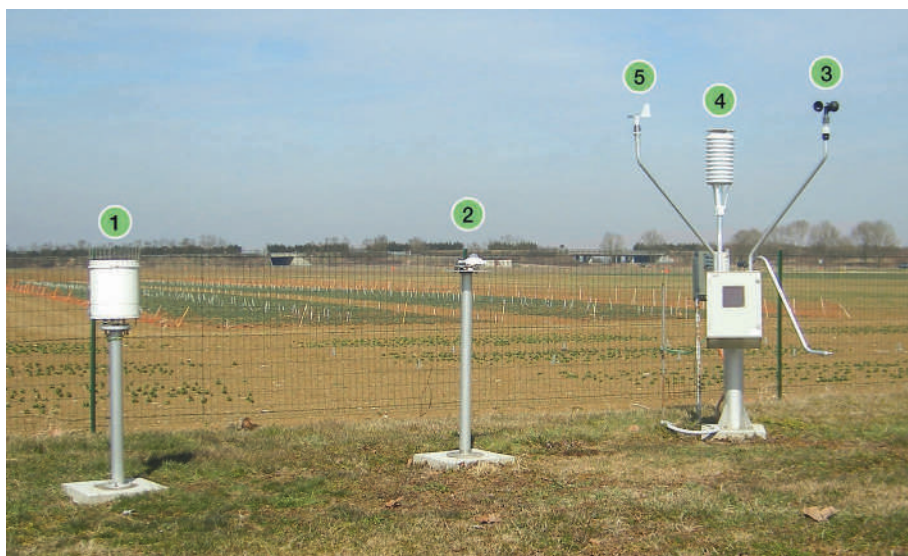
Figure 7.1. Présentation de la station météorologique type du réseau INRAE. © Daniel Roux, INRAE. Station du Site INRAE de Bretenière, Côte d'Or.
