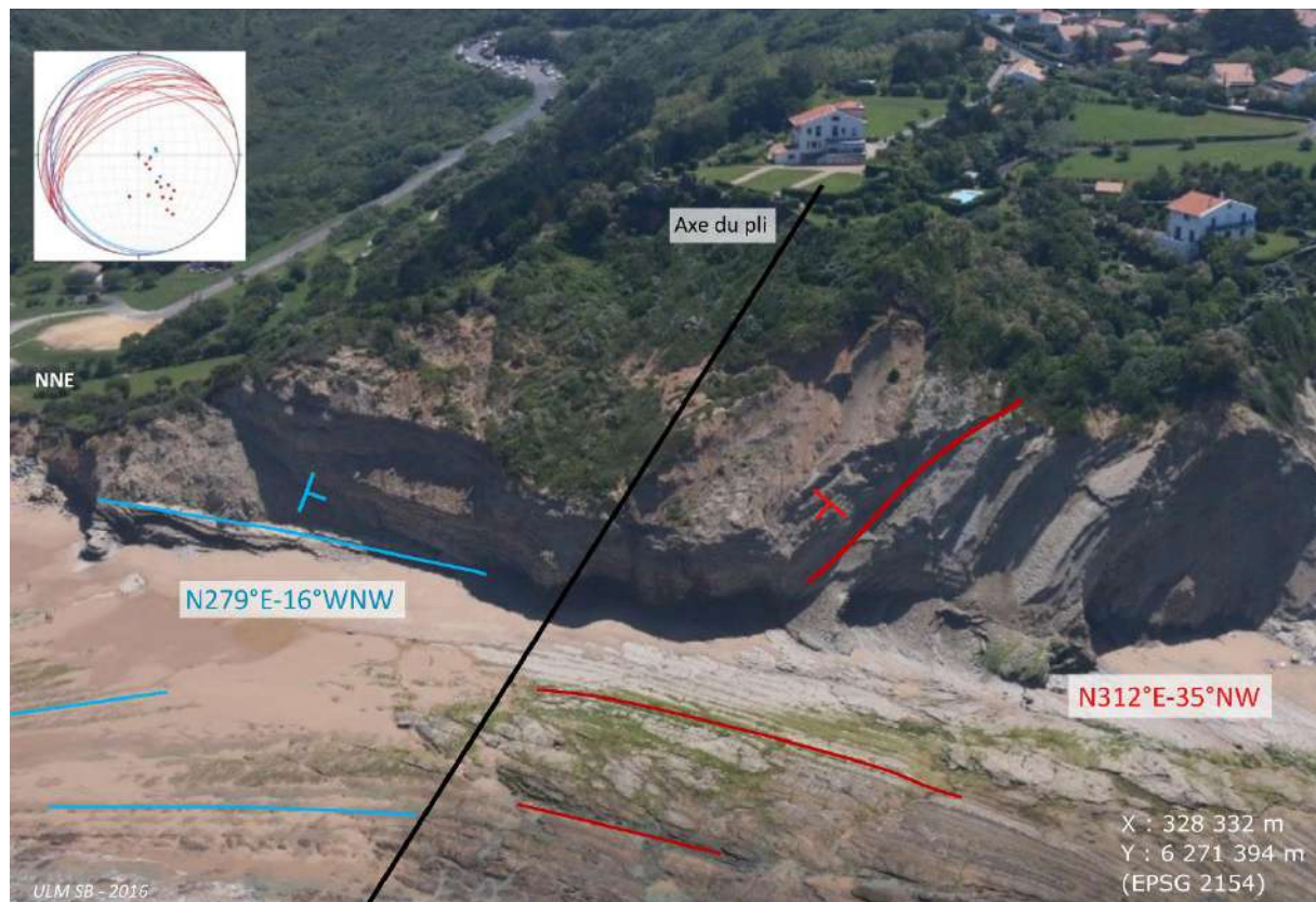
Figure 4.12 : Pli synclinal d'Erretegia sur une photographie de 2016 (ULMSB). Les plans de stratification sont visibles dans la falaise et dans le platier. Le flanc Nord est représenté en bleu. Le flanc Sud est représenté en rouge. Les mesures des deux flancs sont représentées en projection stéréographique en hémisphère inférieure.
