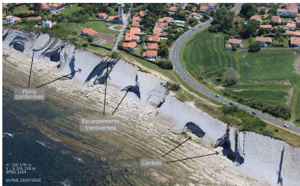
Figure 3.1 : Cavités, plans de stratification conformes à la pente et escarpements transverses caractéristiques de la falaise de Socoa (Ciboure) (photographie aérienne ULMSB 2020). Les escarpements transverses sont constitués d'affleurements dont la surface n'est pas parallèle au plan de stratification.
