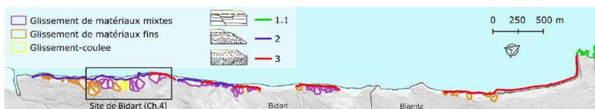
Figure 5.17 : Instabilités gravitaires déclenchées dans les morphotypes 2 et 3.
