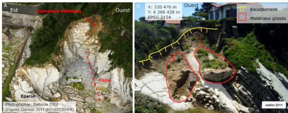
Figure 3.13 : Glissement rotationnel de matériaux fins à l'est du site avant confortement. A : Localisation de l'instabilité (2008) ; B : Zone de départ de l'instabilité en 2011.
