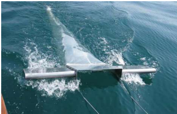
Figure 1.2.1. Déploiement d'un filet Manta (ouverture 60 × 20 cm, maille 333 \mu\text{m} ) sur le Rhône (Arles, 2018).
