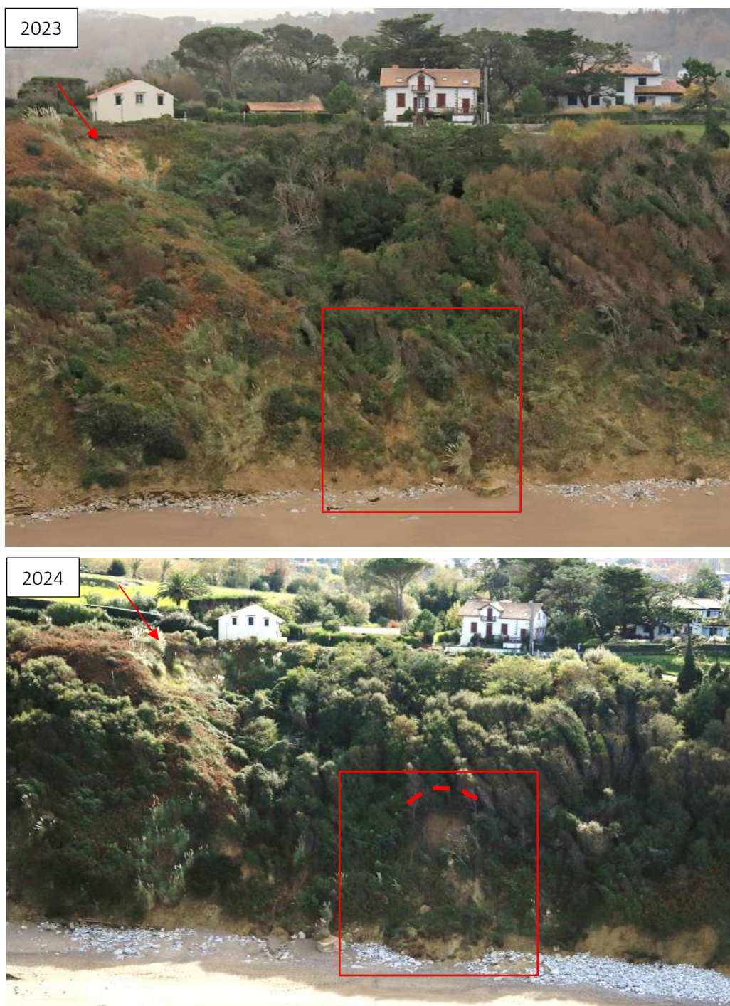
Illustration 47 - Évolution du site 24 entre 2023 et 2024 (encadrés rouges : secteurs d'évolution et flèches rouges : cicatrice d'arrachement du glissement de décembre 2021 ; ©Observatoire de la Côte Nouvelle-Aquitaine, Balloïde 2023 et 2024)
