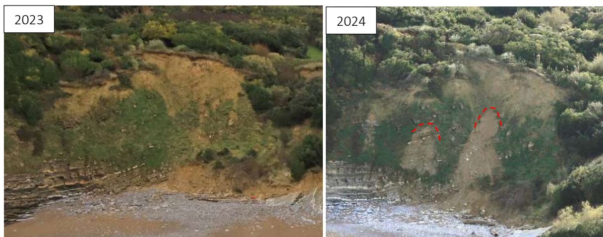
Illustration 55 - Glissements de terrain superficiels, observés sur le site 30, entre 2023 et 2024 (@Observatoire de la côte de Nouvelle-Aquitaine, Balloïde 2023 et 2024)
