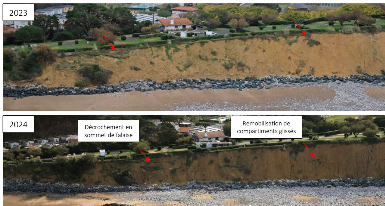
Illustration 49 - Évolution du site 26 entre 2023 et 2024 (flèches rouges : exemples d'évolutions, ©Observatoire de la côte de Nouvelle-Aquitaine, Balloïde 2023 et 2024)
