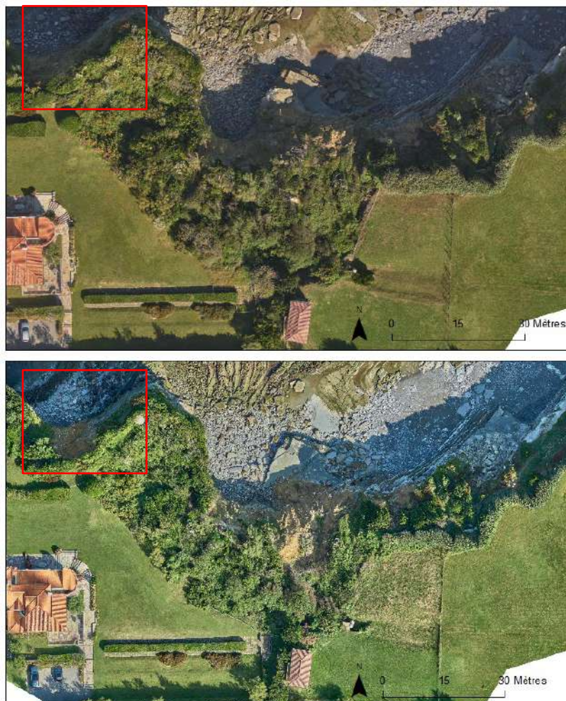
Illustration 58 - Glissement de terrain observé sur le site 31 (encadré rouge : évolution secondaire observée dans le secteur ; Ortho 5 cm, ©Observatoire de la côte de Nouvelle-Aquitaine, Hélimap 2023 et 2024)
