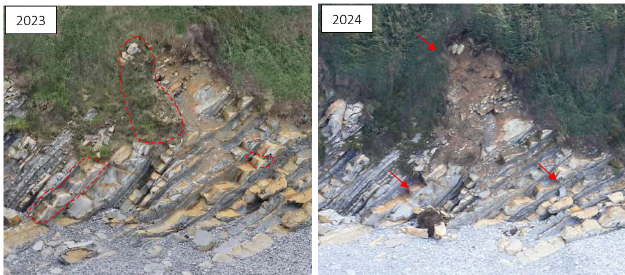
Illustration 94 - Occurrence d'un glissement superficiel et de la rupture de compartiments rocheux sur le site 59, entre 2023 et 2024 (©Observatoire de la côte de Nouvelle-Aquitaine, Balloïde 2023 et 2024)
