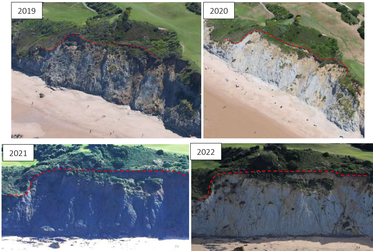
Illustration 9 - Démantèlement des falaises situées au droit du golf d'Ilbarritz entre 2019 et 2022 (site 3 ; pointillés rouges : cicatrice d'arrachement ; ©Observatoire de la Côte Aquitaine, Olivier Chaldebas, ULM Sud Bassin, 2019 ; ©Observatoire de la Côte Aquitaine, Olivier Chaldebas, ULM Sud Bassin, 2020 ; ©Observatoire de la Côte Aquitaine, AirMarine, 2021 et ©Observatoire de la côte de Nouvelle-Aquitaine, Balloïde, 2022)
