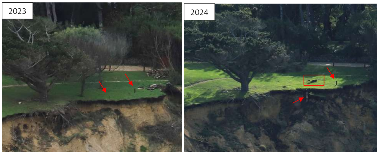
Illustration 41 - Recul du sommet de falaise observé sur le site 20, entre 2023 et 2024 (encadré rouge : un secteur ayant subi des modifications ; flèches rouges : localisation du piézomètre et de l'inclinomètre ; ©Observatoire de la côte de Nouvelle-Aquitaine, Balloïde 2023 et 2024)
