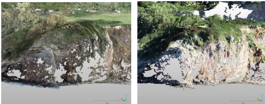
Illustration 18 - Nuage de points 2021 (à gauche) et 2023 (à droite) présentant des absences de données distinctes ne permettant pas de procéder à une analyse des évolutions (ici extrémité de la Pointe Sainte-Anne) (©Observatoire de la côte de Nouvelle-Aquitaine, Instadrone, 2022 et 2023)
