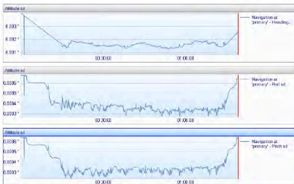
Figure 3 : Précision estimée des angles de la trajectoire : Heading, Roll, Pitch
