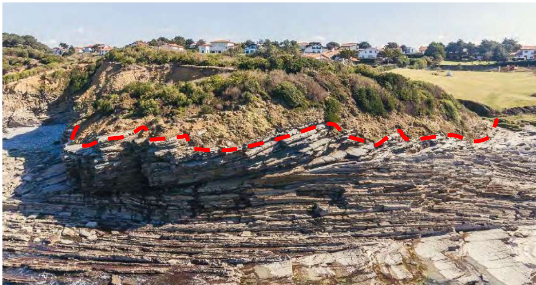
Illustration 6 - Coupe schématique d'un profil d'altération-type dans des calcaires marneux (Genna et al., 2004) et illustration (cliché du bas) dans le secteur de la Pile d'Assiettes (pointillés rouges : délimitation approximative entre altérites et flyschs « sains ») (©Observatoire de la Côte Aquitaine, Com' by AVM)
