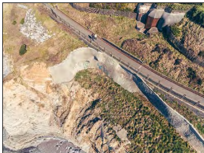
Illustration 10 - Glissement de terrain de la Promenade Feodor Chaliapine, le 03/12/2002, bordant l'ancienne route (à gauche), et vue aérienne du confortement actuel de cette partie de falaise (cliché de droite daté 2018) (©Observatoire de la Côte Aquitaine, Com' by AVM)
