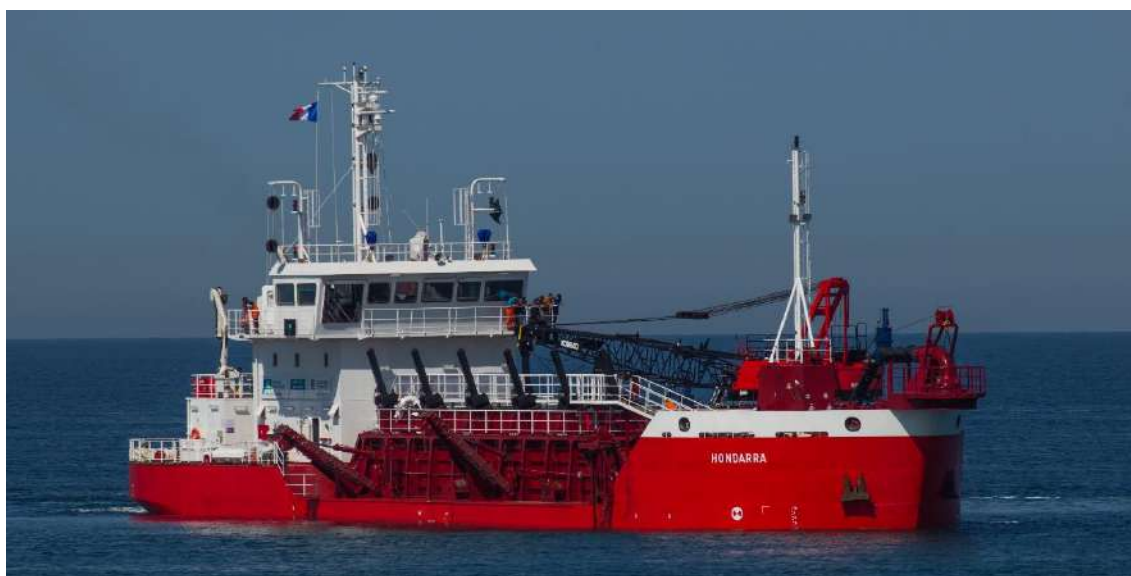
Figure II. 18 : Drague mixte Hondarra.
