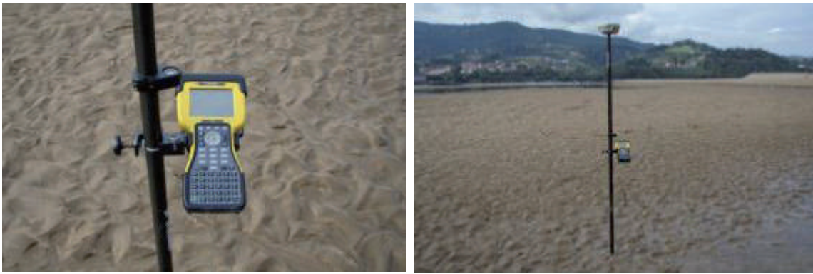
Figura 1. GPS Trimble R6 utilizado para la obtención de la coordenadas geográficas de las manchas de Zostera noltii en 2012.
